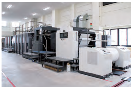
ロールフィーダーで連続給紙する V3000TP-8+LED-UV
